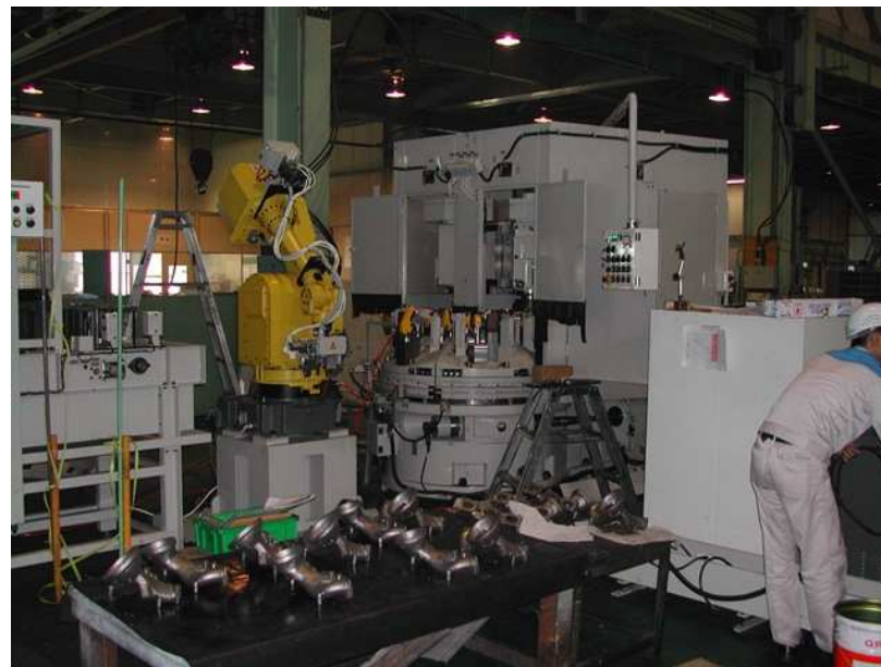
ワーク自動取付けロボットによるロータリーフライス盤のインライン化
