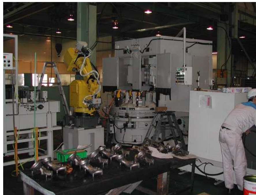
ワーク自動取付けロボットによるロータリーフライス盤のインライン化
